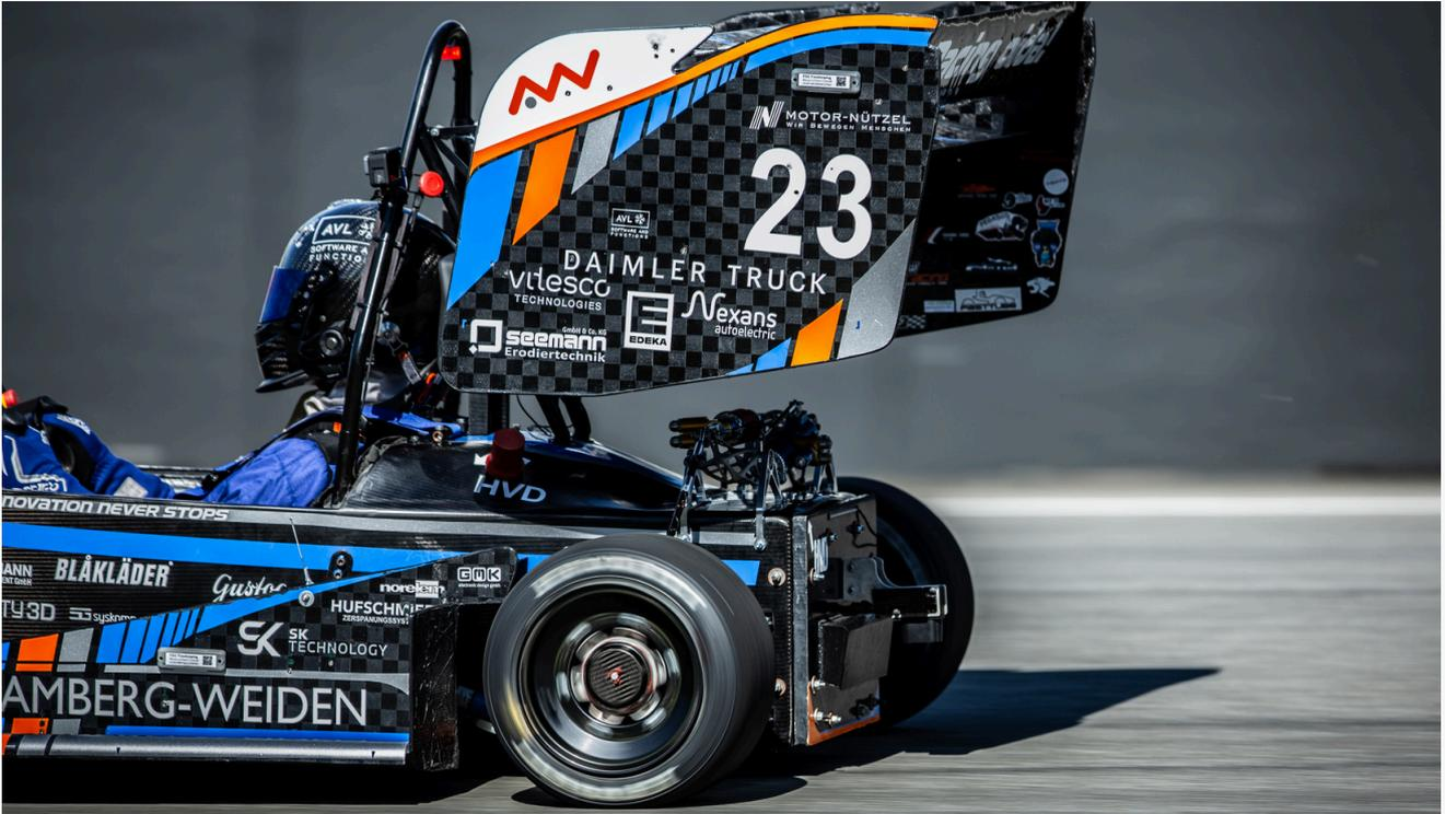
In den letzten Monaten hat unser Team intensiv an der Weiterentwicklung neuer Fertigungstechniken gearbeitet, um die Gestaltungsmöglichkeiten für unsere Fahrzeugkomponenten zu erweitern. Besonders hervorzuheben ist der Einsatz von 3D-Druck als Kernmaterial für die Flügelprofile. Diese neue Fertigungstechnik ermöglicht uns eine noch nie dagewesene Freiheit in der Formgebung und eine präzisere Fertigung der aerodynamischen Bauteile. Dank dessen können wir innovative Designs realisieren, die mit
